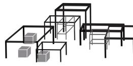
それでも耐力が持たないLフレームの柱の足元にSサイズの部屋を配置
