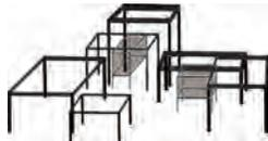
耐力が持たない箇所を補うかつ他のLフレームと連結させる様にMフレームを配置
